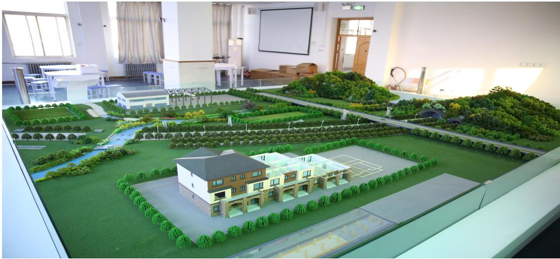
(2) 摄影测量仿真实训系统包括地形模型、航测导轨、LED显示屏和仿真控制装置。地形模型含有高山丘陵、平原和湖泊、海洋等多种地貌特征，也含有高楼、一般房屋、临时建筑、公路、铁路、桥梁、工业设施等典型地物，在模型内设置了平面控制网如闭合、附和、支导线等导线平面控制网、GPS平面控制网和水准测量高程控制网。能直观展示地形各要素。配合观测墩能使用全站仪进行地形图的仿真实训；航测导轨上安置无人机相机，模拟无人机在天空中按预定航线开展摄影测量作业，并将航测影相数据传输到控制系统存储，并实时展示在大屏幕上，能观看航测的作业过程及数据传输功能；通过控制系统还可以展示数据的处理过程及生成的4D产品、以及三维校园数字模型。配备四旋翼无人机20台，六旋翼无人机6台，八旋翼无人机1台，固定翼无人机1台及图形处理工作站。开展无人机组装调试、无人机操控模拟飞行、固定翼和旋翼无人机实际操作飞行、无人机摄影测量作业、航测影像数据传输与处理、生成4D成果输出等训练。
